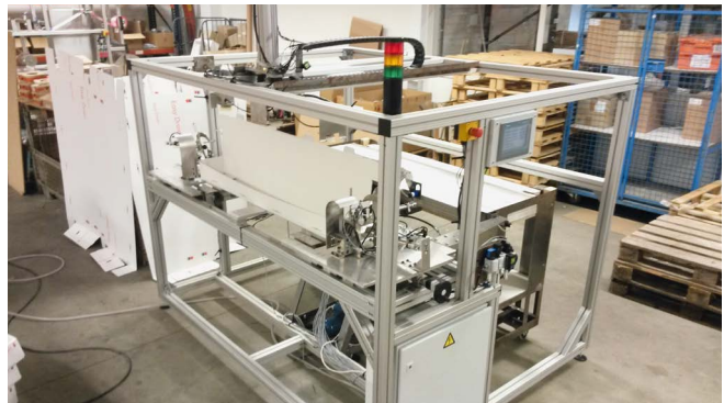
Het 'Boxfolding Device' is een uit modulaire profielen opgebouwd machineframe met mechanische, elektromechanische, pneumatische/vacuüm en digitale componenten die onder controle staan van een PLC. De verschillende soorten dozen worden automatisch herkend, waarop de aanslagen en vouwarmen direct op de juiste lengte en breedte worden ingesteld.
